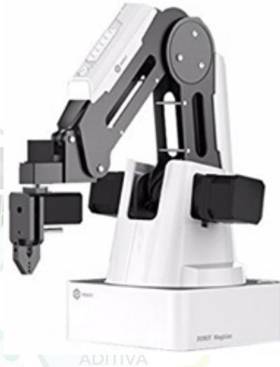
Magician es un brazo robótico de escritorio multifuncional para la formación práctica. Instalado con diferentes herramientas finales, DOBOT Magician puede realizar funciones interesantes como impresión 3D, grabado láser, escritura y dibujo. Es compatible con el desarrollo secundario mediante 13 interfaces extensibles y más de 20 lenguajes de programación, lo que realmente hace que su creatividad e imaginación aumenten sin ninguna limitación.
