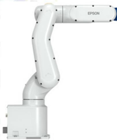
El VT6L tiene muchas de las funciones que se encuentran en los robots más avanzados de Epson, como el poderoso software de desarrollo Epson RC+® y las herramientas que facilitan la integración como la guía de visión y posee además un alcance de hasta 900 mm y una carga útil de hasta 6 kg.
